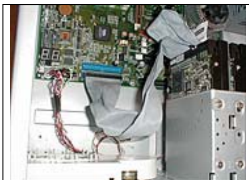
اتصال کابل های ریبون IDE هاردرایو
