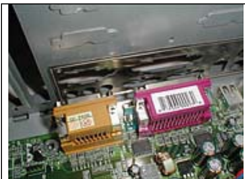
برجستگی کانکتور پشتی باید با سوراخهای داخل صفحه برجسته ATX فیت شوند.
